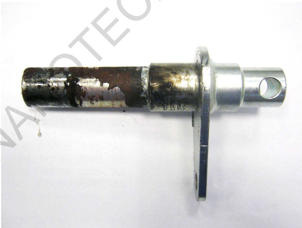
Foto č.12 – horní čep zvedacího táhla namazaný mazivem POLYMER 400
