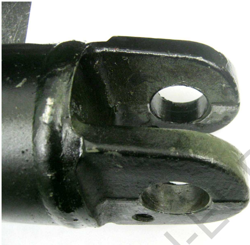
Foto č.23 – vidlice válce s mazivem Rolsfer EP_Nanotech N1 GH – X
