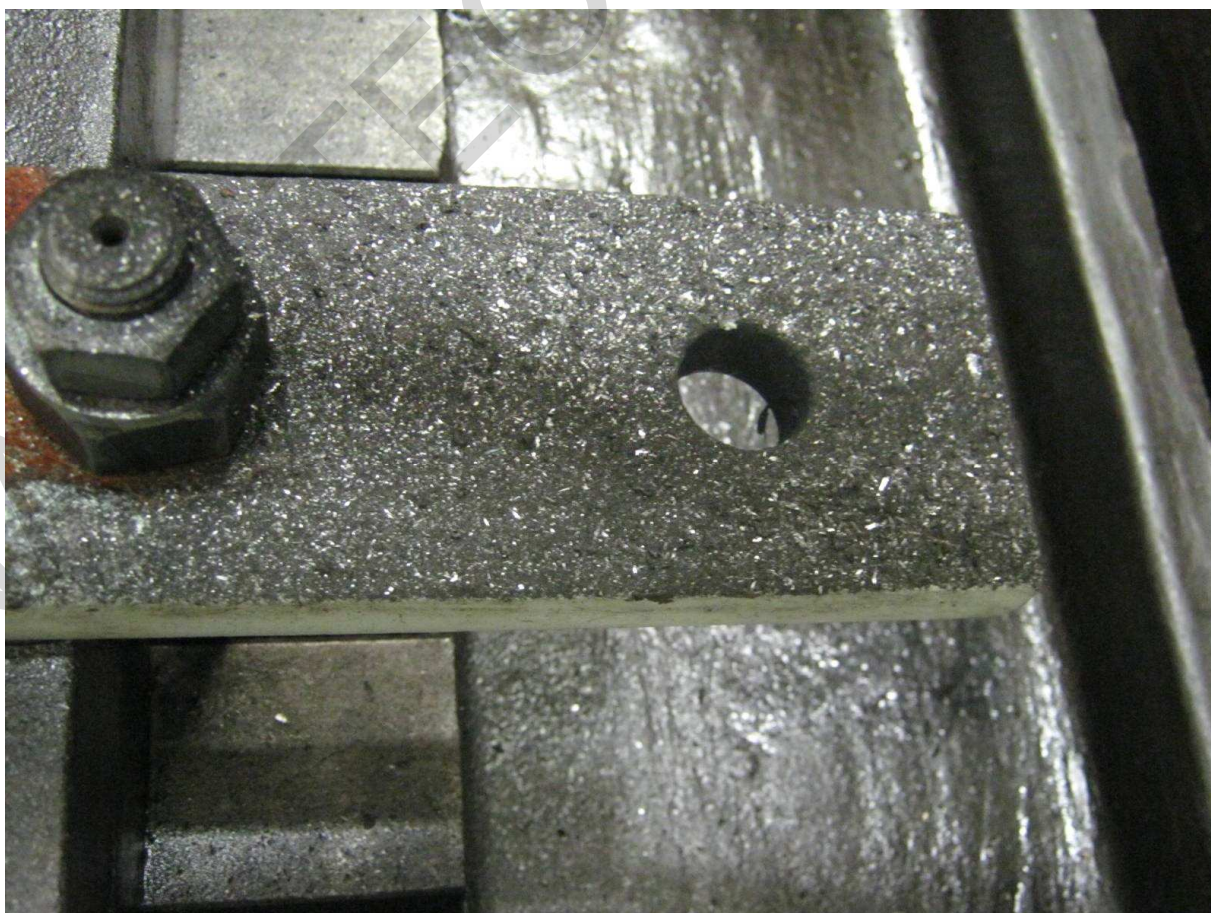
Foto č.4 – otěr pod čepem namazaným mazivem POLYMER 400
